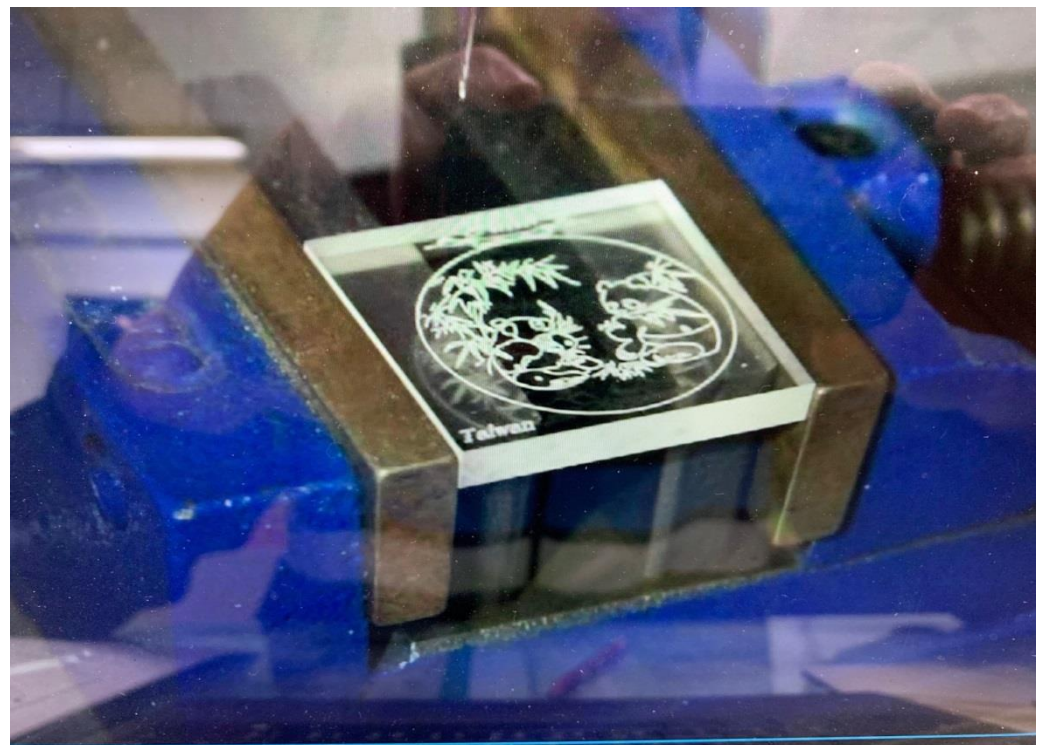
圖 13-4 CNC 雕銑機完成 2.5D 產品
