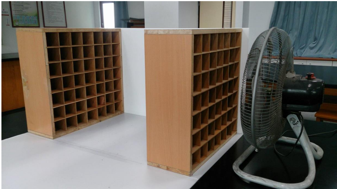
圖 9：簡易風洞整流段
