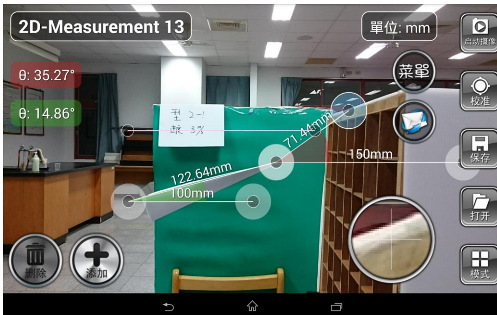
圖 11：APP 軟體[ON 2D 遠程量測]進行遠距角度量測圖
