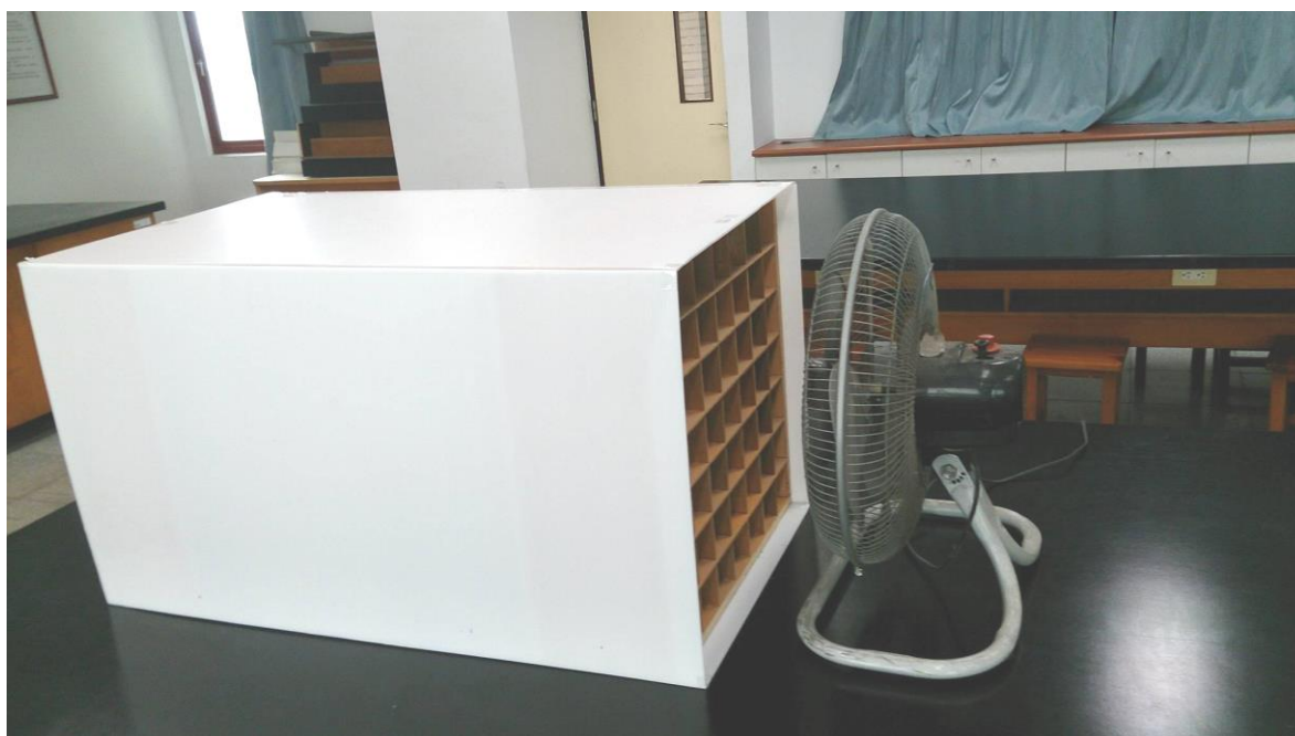
圖 8：簡易風洞動力段
