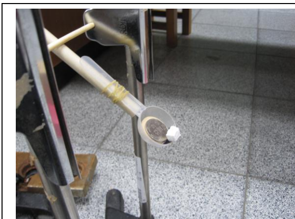
使硬幣正轉的作法： 在勺子前端增加一個小的障礙物
